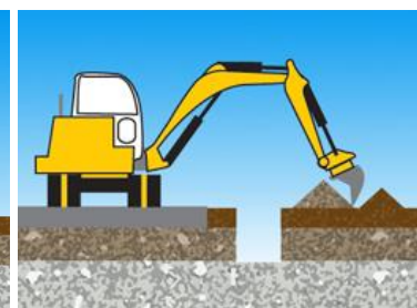
Reprise des matériaux de l'horizon inférieur depuis un chemin existant adjacent à la fouille (emprise d'environ 5m de largeur).
